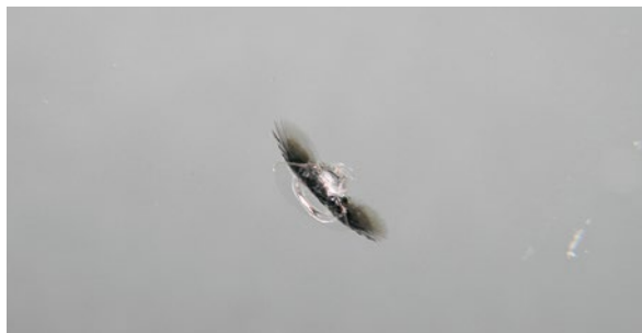
Следствие на силен удар от насекомо
