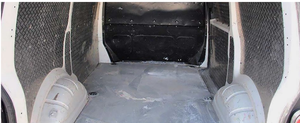
Недопустими признаци на износване на зоната за товарене
