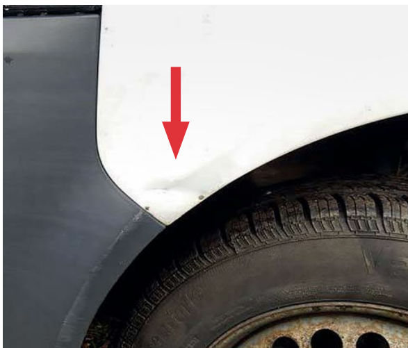
Силно повреден калник
