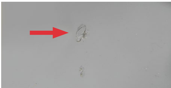
Некачествен ремонт след удар на камъче на предното стъкло
