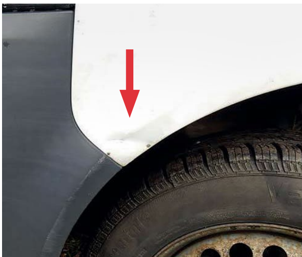
Силно повреден калник
