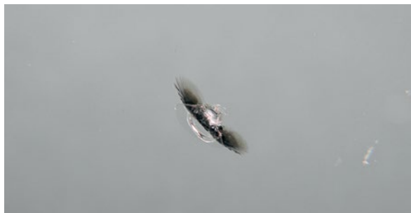
Следствие на силен удар от насекомо
